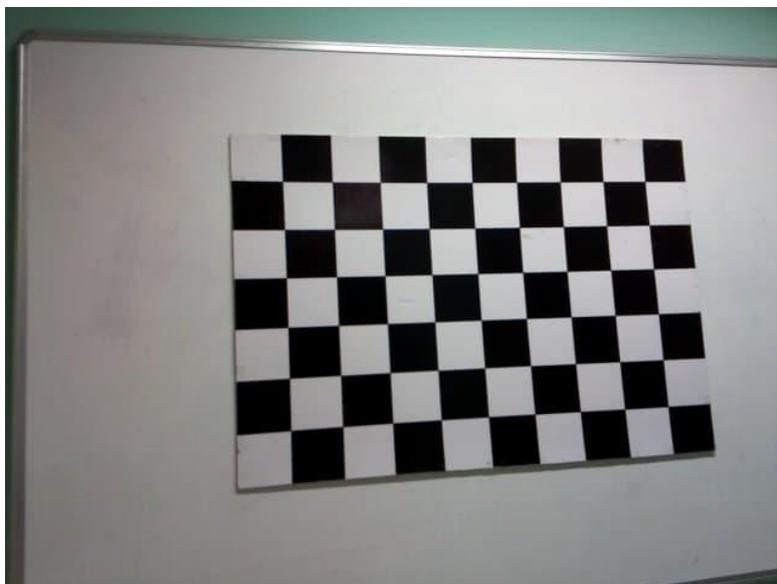
2. 计算 2D 图片中各个拐角的坐标：找出棋盘图的拐角、Refine 棋盘图拐角。注意这里的二维坐标，对于某个特定点，他在不同图片下的二维坐标是不一样的。
