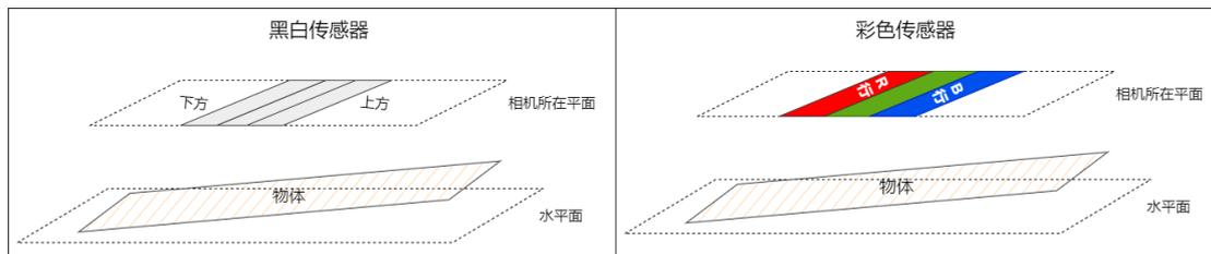
2.2 产生如上猜测的原因来自切向畸变，下图是一个平面相机的切向畸变的图示，注意线性相机下纵坐标不会有这样现象：
